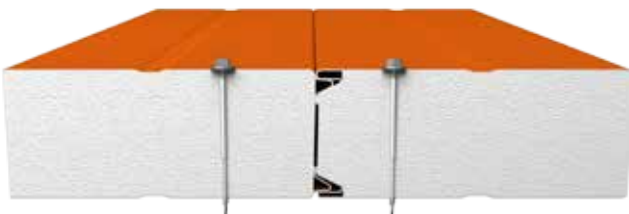
Dıştan Vida Cephe Paneli Birleşim Detayı Outer Screw Wall Panel Connection Detail
